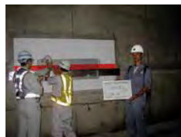
汚染物付着状況での 反射率測定
